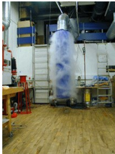
Röktest som demonstrerar deplacerande ventilation från vertikala don
